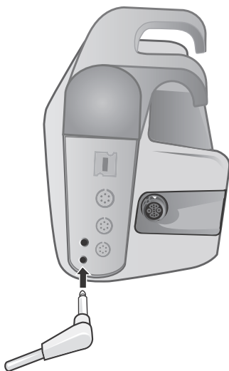
Figura 12-1 Collegamento della sonda della temperatura all'unità X Series Advanced
