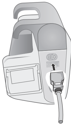
Figure 10-3 Collegamento del sensore SpO 2 all'unità X Series Advanced
